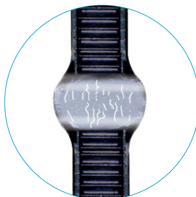
Sin protección UV
