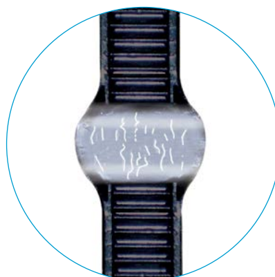
Sin protección UV
